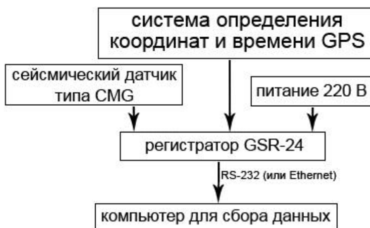
Рисунок 11 – Схема соединения основных частей системы станции типа GSR-24
