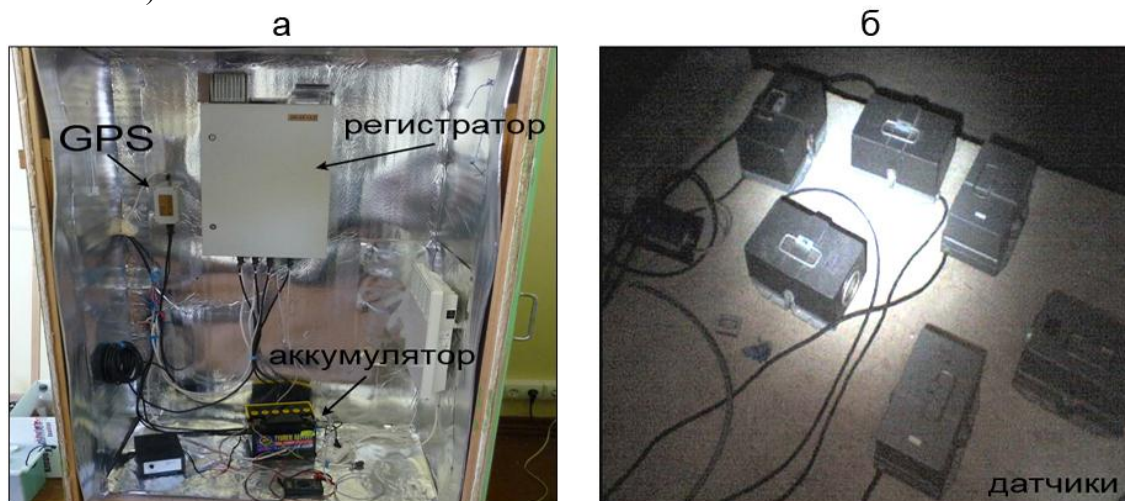
а – регистратор станции типа SDAS v3.0 (в термоизоляционном шкафу), б – два комплекта сейсмодатчиков, установленных в бункере с/с «Климовская»
